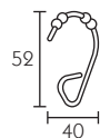
524009 Gancio con sfere Sphere hook Crochet à roulettes Röllenhaken Gancho con esferas Haczyk z kulkami
